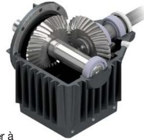
Exploitez totalement la puissance de votre tracteur sans contrainte avec des débits allant au-delà de 100 t/h. Le boîtier à engrenages spirales permet de transférer 300hp (puissance PDF) sans souci. Un refroidissement efficace et une lubrification à l'huile synthétique garantissent une grande durabilité.
