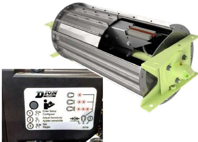
Grâce à un capteur de vitesse sur la tête de coupe et les rouleaux d'alimentation, une fonction anti-bourrage assure un arrêt immédiat des rouleaux en cas de surcharge de la tête de coupe (bris de boulon de cisaillement). Des alarmes détaillées permettent de déterminer rapidement les causes des arrêts subits ou diagnostiquer des problèmes potentiels.
