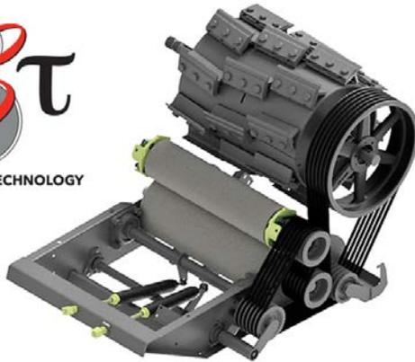
Un rouleau inférieur de 250mm (10po) est jumelé à un plus petit de 150mm (6po) et tournent tous les deux à près de 4000 rpm. Ils sont positionnés directement dans la trajectoire de l'ensilage, donc on évite les changements de direction qui consomment de l'énergie. Obtenez l'ensilage désiré à tout moment en ajustant le degré de traitement. Cet ajustement se fait en quelques secondes, avec une seule clé, par l'écartement des rouleaux, tout simplement.
